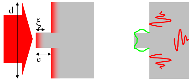
FIGURE 2.14: Géométrie de l'expérience pour un nano-objet. Les faisceaux de pompe et de sonde sont tous deux focalisés sur une zone contenant des nanostructures. La profondeur d'absorption et la taille des objets sont comparables. Cette géométrie permet la génération des modes propres de la particule (vert) et de lancer des ondes de polarisations longitudinales et transverses (rouge).
