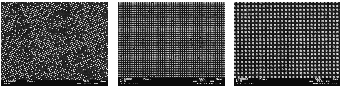
FIGURE 2.5: Résultat des essais de dose sur aluminium. Les cubes ont une taille d = 100 \text{ nm} et le pas du réseau est a = 200 \text{ nm} . Les doses sont de gauche à droite 270 , 285 et 300 \mu\text{C}\cdot\text{cm}^{-2} . Pour des doses insuffisantes les motifs n'ont pas adhéré à la surface.
