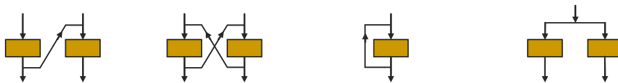
Figure 03 : Sémantique d'une construction résultant de la mise en relation de deux briques monovalentes : (a) action, (b) interaction, (c) rétroaction, (d) parallélisme.
