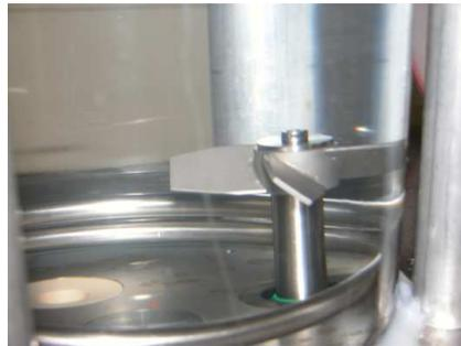
FIGURE 2.9 – Photo d'une hélice prise lors des mesures préliminaires avec de l'eau.
