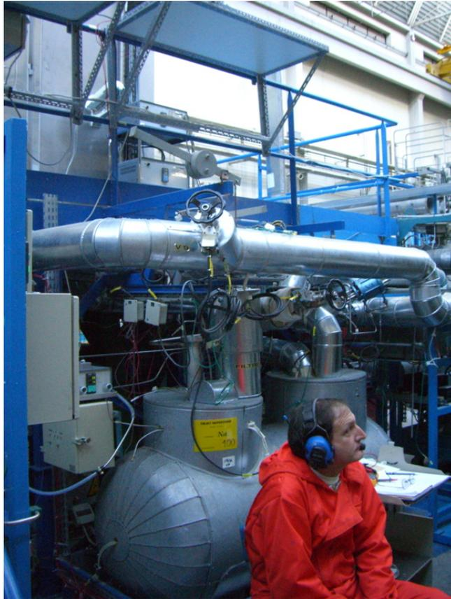
FIGURE 2.2 – Photo du circuit de recirculation de l'expérience *VKS* avec au premier plan André Skiara. On remarque en particulier la cuve de stockage au point le plus bas de l'expérience, tandis que la cuve d'essai est montée sur une plate forme.
