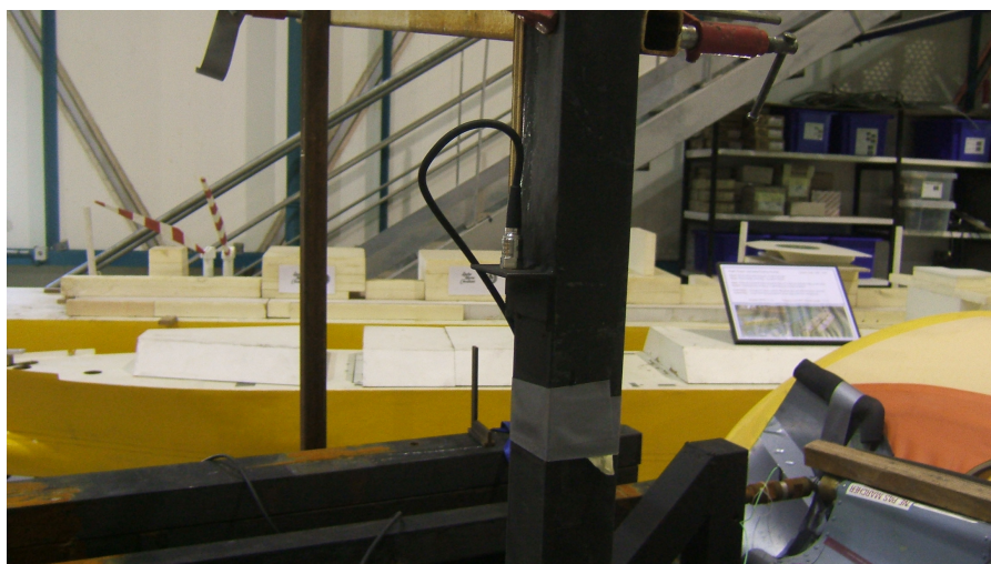
FIG. 7.7 – Accéléromètre central, placé sur le mât par lequel la maquette est suspendue
