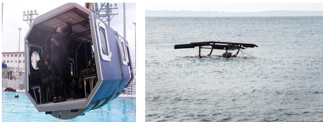
FIG. 1.7 – A gauche : Formation des personnels navigants à l'amerrissage d'urgence ( http://www.safetycenter.navy.mil ). A droite : Hélicoptère non équipé de système de flottabilité ( http://www.mvgazette.com/ )
