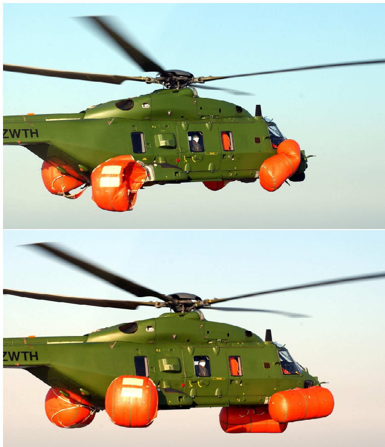
FIG. 7.1 – Système de flottabilité d'un hélicoptère NH90 en cours de gonflage (haut) et complètement gonflé (bas)
