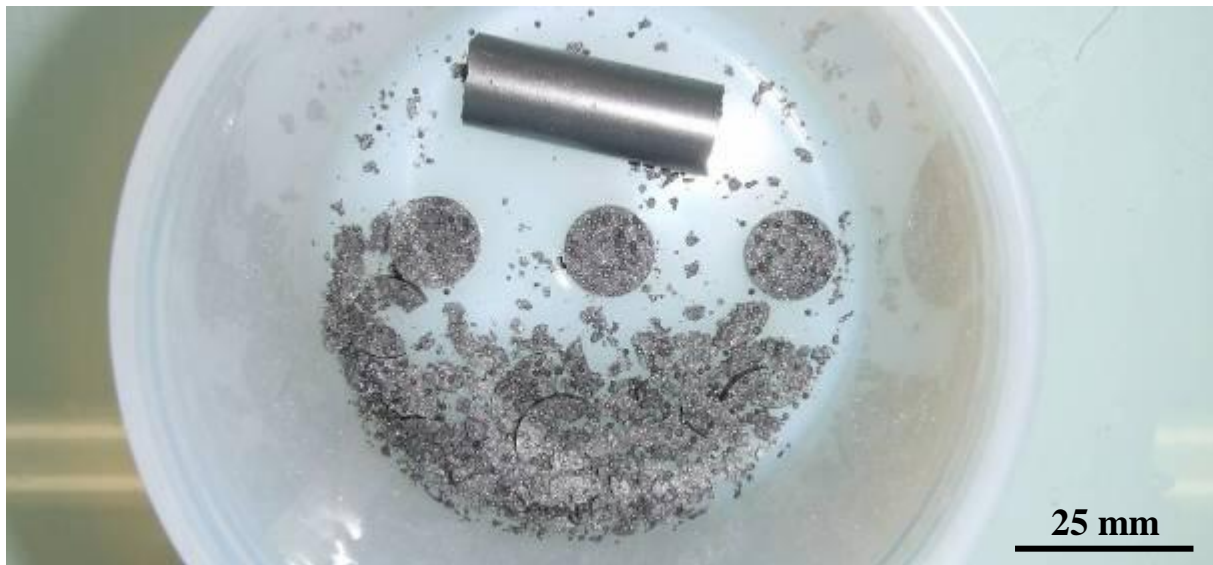
Figure 34 : Morceaux d'un compact à 10 % après une rupture liée à un transfert entre l'azote liquide et de l'eau chaude (85 °C)
