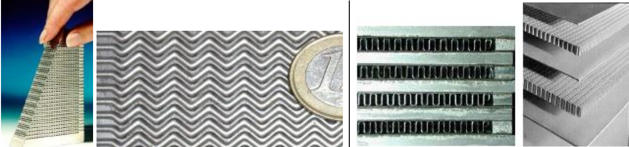
Figure 3 : Échangeurs de chaleur : géométrie PCHE à gauche et PFHE à droite
