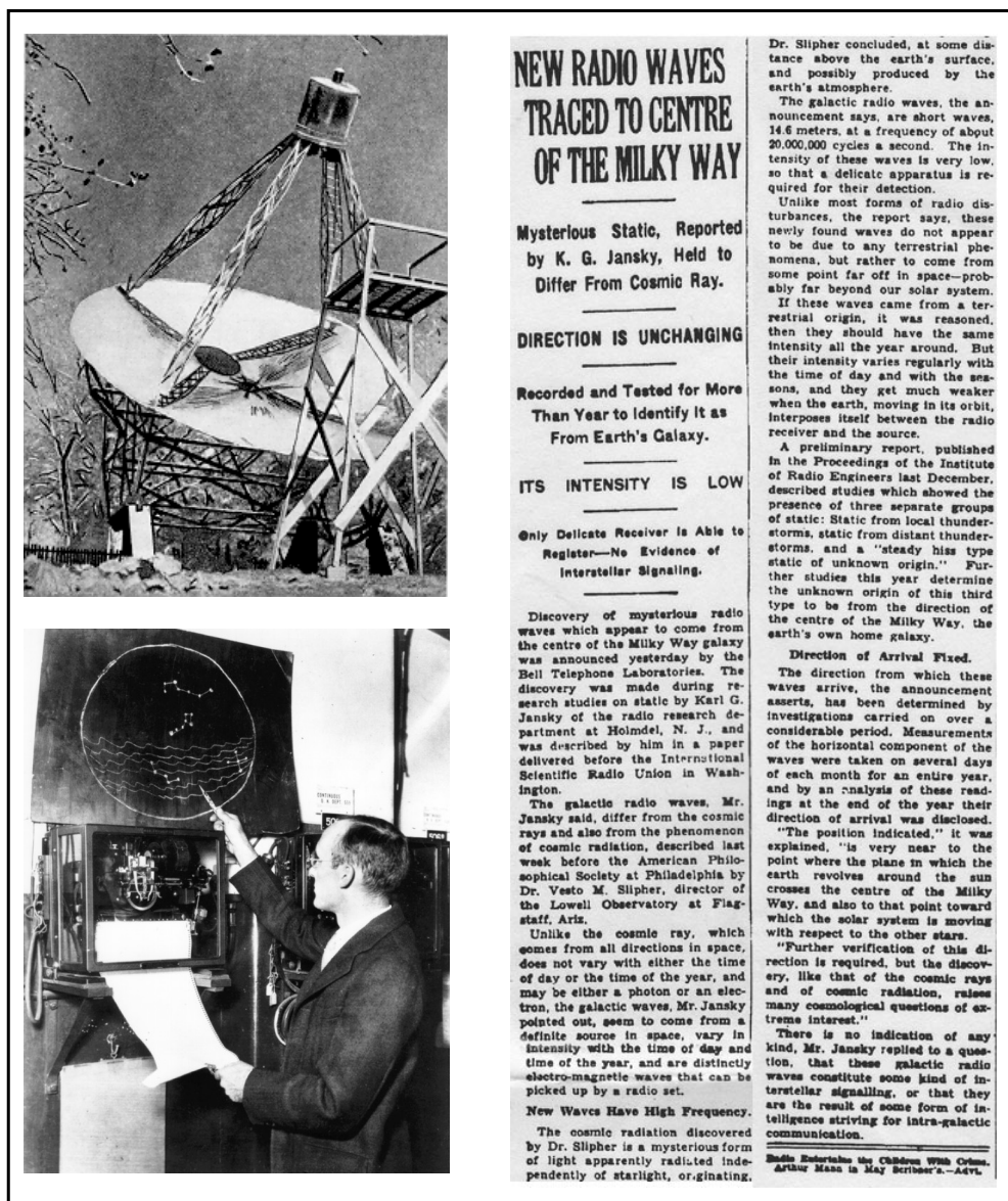
FIGURE 4.1 – En haut à gauche : le premier radiotélescope. Son diamètre était de 10 m, et il permit à Grote Reber de produire une première carte du ciel à 160 MHz. A droite : publication de la découverte de Jansky, dans le new York Times du 5 mai 1933. Le lecteur attentif peut noter l'accent mis sur la nature "non-intelligente" du signal détecté. En bas à gauche : Karl Jansky indiquant le plan galactique, à l'origine de l'émission radio détectée. On peut clairement distinguer sur son dessin la constellation de Cassiopée, très facilement reconnaissable grâce à sa forme de W. Dans la mythologie grecque, la reine Cassiopée était la femme de Céphée et la mère d'Andromède, à côté desquels elle se trouve sur la voûte céleste. Elle voulait disputer aux Néréides, nymphes de la mer, le prix de la beauté. Poséidon, irrité de son audace, fit ravager son royaume par un monstre marin, et l'obligea à exposer sa fille Andromède à la fureur de ce monstre. Cassiopée est donc, après sa mort, enchaînée à son trône, condamnée à tourner autour du pôle Nord, et ainsi pend parfois à l'envers, de façon très peu digne.
