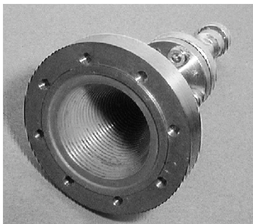
FIGURE 4.4 – Un cornet ondulé utilisé sur le 30-m pour la bande à 150 \text{ GHz} . La lentille correctrice de phase présente normalement à l'entrée du cornet a été enlevée afin d'apercevoir les ondulations du cornet. Le diamètre d'ouverture de ce cornet est approximativement celui d'une pièce de monnaie. Toutes les ondes collectées par l'antenne de 30 \text{ m} convergent vers le cornet avec une relation précise entre leurs phases, et sont ensuite envoyées dans un guide d'ondes de 2 \times 1 \text{ mm} de diamètre.
