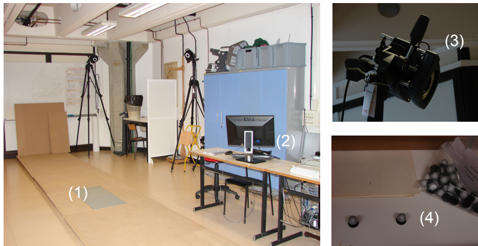
FIGURE 3.11 – Capture de mouvement optoélectronique Vicon Motion Systems Ltd (UMR 6600) : (1) plates-formes de force AMTI ; (2) station de travail ; (3) caméra ; (4) marqueurs
