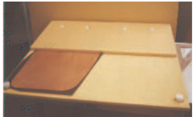
(b) Installation de la 2 ème couche de mousse
