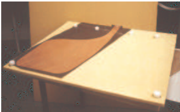
(a) Installation de la mousse et du substrat Duroïd
