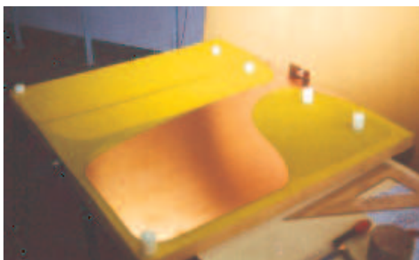
(a) Assemblage des plaques d'époxy
