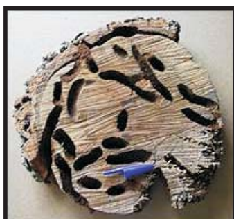
Figura 4.38. Acción de los xilófagos sobre la madera
