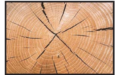
Figura 4.31. Fisuras debidas a fríos intensos
