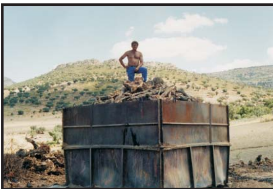
Figura 6.31. Caja metálica donde se cuece leña de menor calidad y se obtiene carbón de menor calidad.
