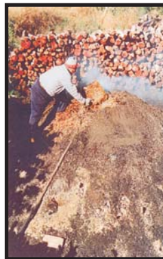
Figura 6.8. Tapando la chimenea
