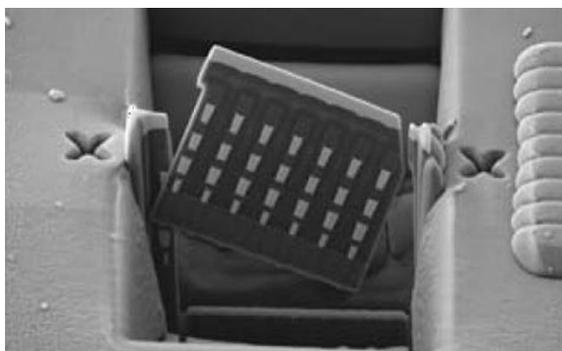
FIG. 2.3 – Lift-off d'une préparation TEM
