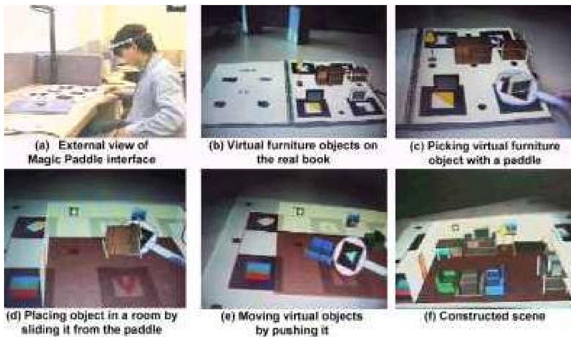
FIG. 1.29 – Utilisation d'interfaces tangibles pour la sélection/manipulation en RA : Le "Magic Paddle [DSD + 02]".
