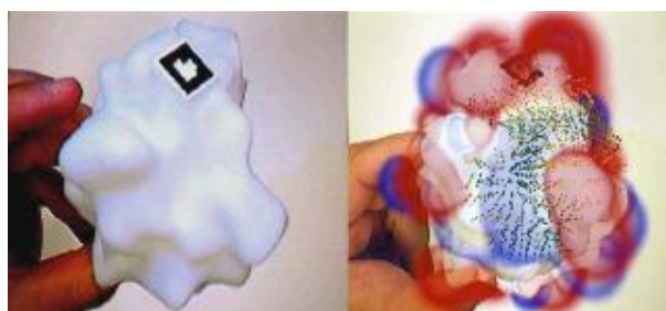
FIG. 1.34 – Utilisation d'interfaces tangibles pour la sélection/manipulation en RA : Modèle physique par prototypage rapide de protéine (Superoxyde dismutase) augmenté par le champ électrostatique.
