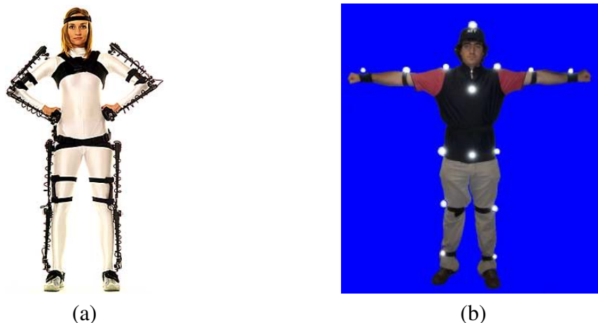
FIG. 1.19 – Systèmes de capture de mouvement : Système à armatures mécaniques Gypsy5 TM [ani] (a) et système optique MotionCaptor TM [sim] (b).
