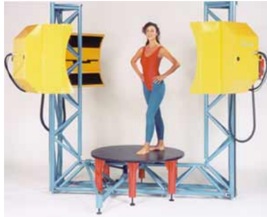
FIG. 2.7 – Exemple de scanner 3D : le whole Body 3D scanner de Cyberware.
