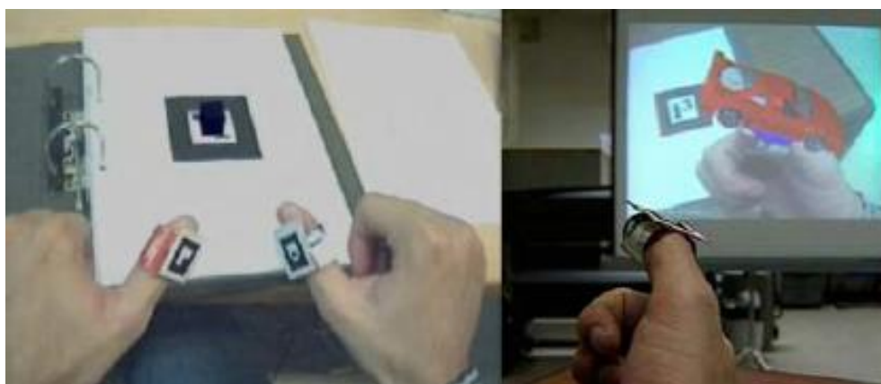
FIG. 1.30 – Utilisation d'interfaces tangibles pour la sélection/manipulation en RA : Le "Magic Ring".
