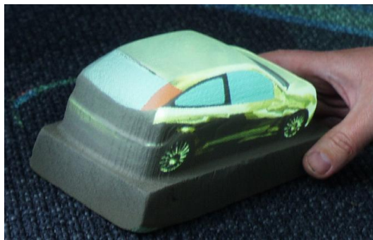
FIG. 2.3 – Prototype réel augmenté par projection [VdSPvG03].
