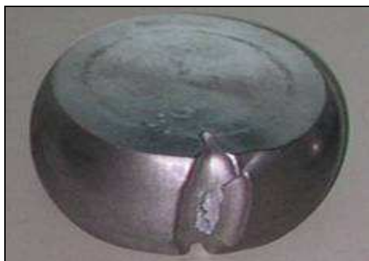
Figure 5.12 : Epreuve TELE avec rupture dans l'entaille
