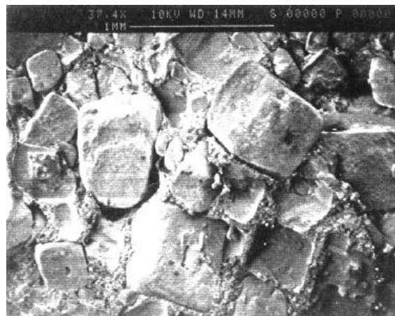
FIG. 1.5 – Microstructure de l'IEX3 après une compression uniaxiale quasi-statique : décohésion aux interfaces matrice/gros grains [CAG87]
