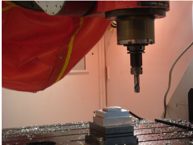
Figure 4.3 – Mesure des efforts d’usinage en contournage avec une table Kistler
