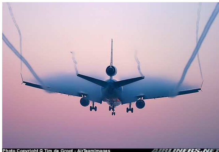
FIG. 1.1 – Sillage d'un avion dans le champ proche en phase d'approche, illustr   par la vapeur d'eau pour des conditions atmosph  riques tr  s particuli  res (@airliners.net).
