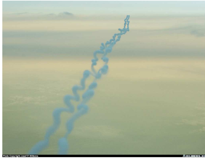
FIG. 1.2 – Sillage d’un avion dans le champ moyen, illustré par l’éjection de fumées lors de tests grandeur nature (@airliners.net).
