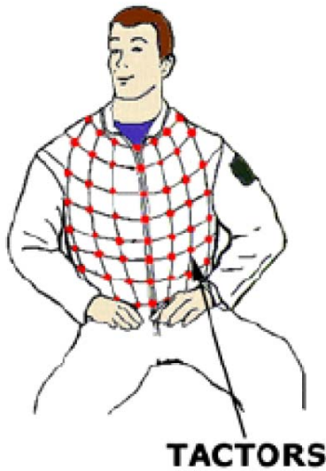
Figure 52. Le gilet de stimulation tactile développé par l'Armée Américaine pour les pilotes d'hélicoptères. D'après Mars, 2001.
