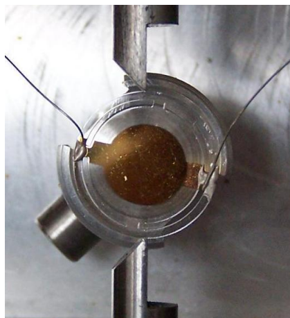
FIGURE 4.19: Dispositif de centrage du résonateur pour mesure de l'effet force-fréquence.
