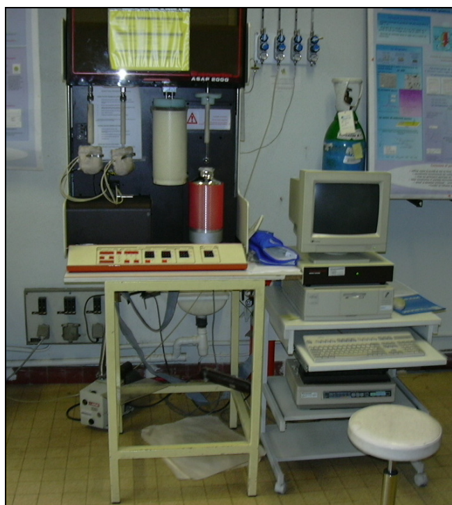
Figure A- 2 : Photo de la machine BET utilisée pour l'évaluation de la surface spécifique de nos échantillons.
