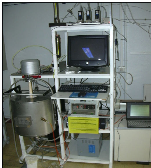
Figure A- 3 : Photo de la machine thermogravimétrique utilisée pour l'évaluation de la capacité d'adsorption de nos échantillons.
