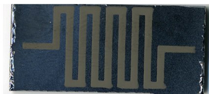
Figure IV- 1 : Image photo de la résistance chauffante du microréacteur.
