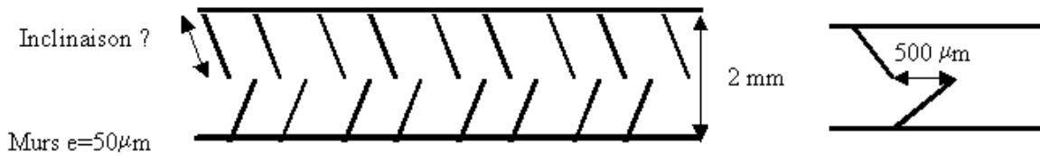
Figure A- 15 : Diagramme schématique des structures en forme d'écaille dans les microcomposants IMT 1 de design « écaille » (détail 1)
