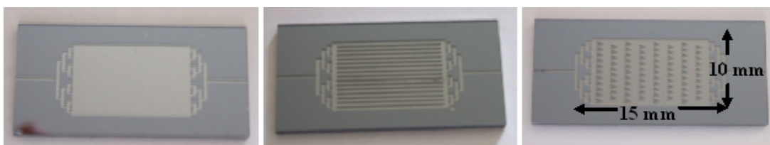
Figure III- 15 : Photos des trois types de design de microcomposants série 2 : neutre (gauche), parallèle (Centre) et chicane (droite).
