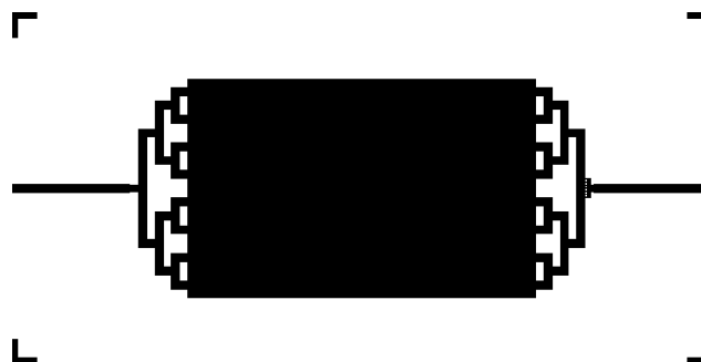
Figure A- 20 : Diagramme schématique d'un microcomposant IMT 2 de design « neutre ».
