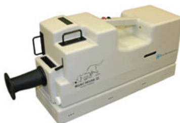
Figure I- 17 : Photo d'un détecteur d'explosifs basé sur la préconcentration développé par SANDIA National Laboratories (USA) [32].
