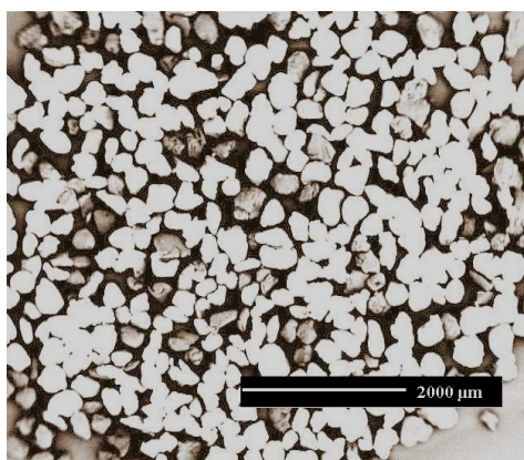
Figure II- 9 : Images MEB des particules de polymère Tenax TA.
