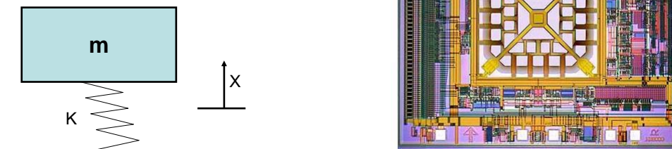
FIG. 2.4 – (gauche) Principe de l'accéléromètre, (droite) Exemple d'accéléromètre MEMS (MEMSIC, Inc)
