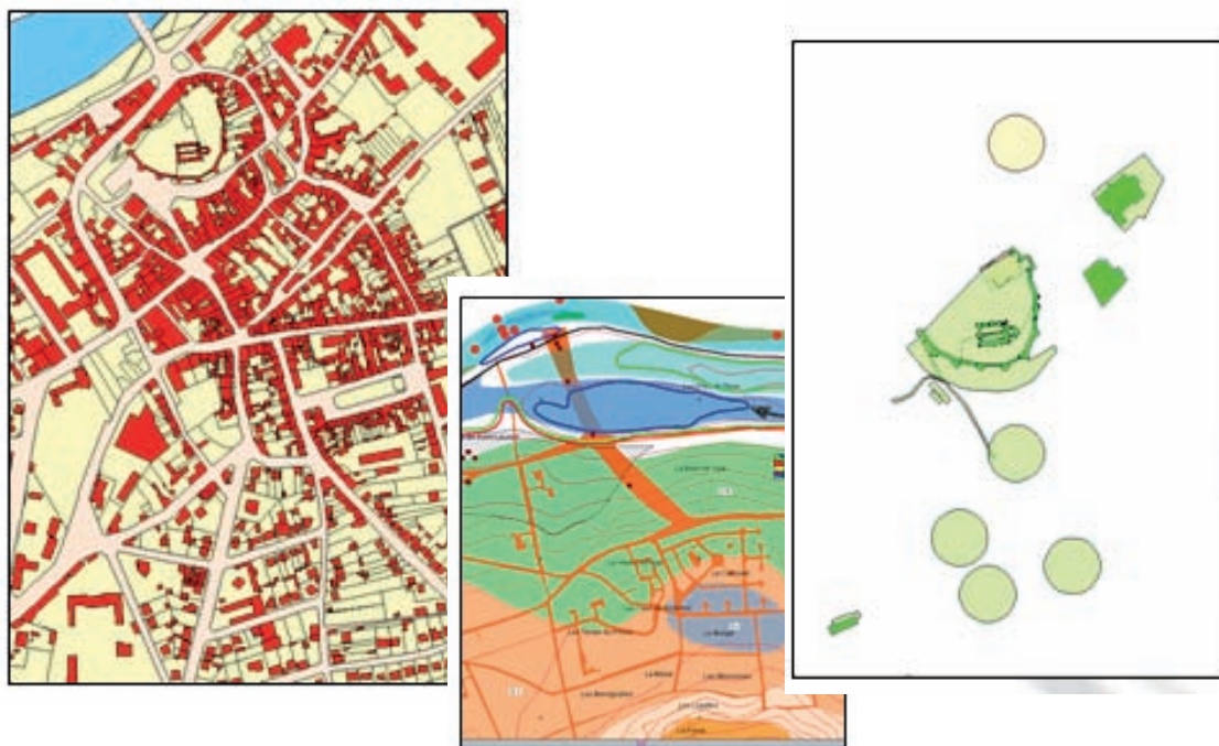
Fig. 58 - Les étapes de constitution de la carte de base : 1 – constitution du fond de référence ; 2 – enrichissement du fond par l'acquisition des données environnementales ; 3 – intégration des données du patrimoine.
