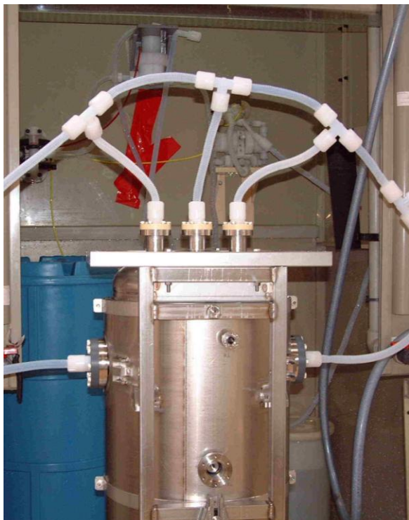
Figure 3-47 : (a) : Mise en place de la circulation fermée. Vue sur les brides de fermetures et visserie plastique. Toutes les ouvertures de la cavité sont reliées pour éviter toute stagnation. (b) : Cavité placée dans un espace clôt sous la hôte et totalement équipée avec la circulation d'acide. Photographie prise sur le site du CEA Saclay.
