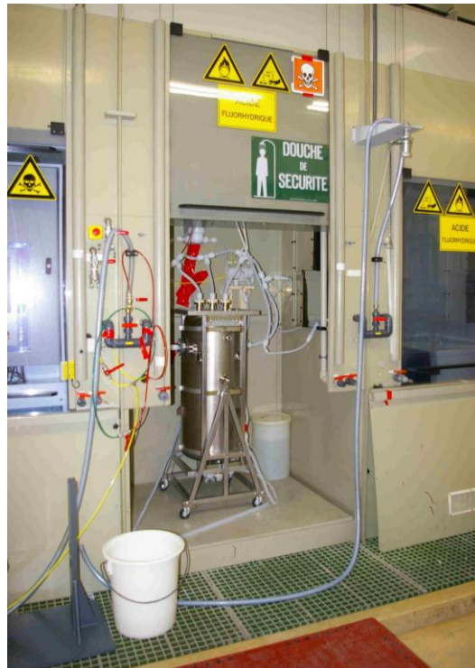
Figure 3-47 : (a) : Mise en place de la circulation fermée. Vue sur les brides de fermetures et visserie plastique. Toutes les ouvertures de la cavité sont reliées pour éviter toute stagnation. (b) : Cavité placée dans un espace clôt sous la hôte et totalement équipée avec la circulation d'acide. Photographie prise sur le site du CEA Saclay.
