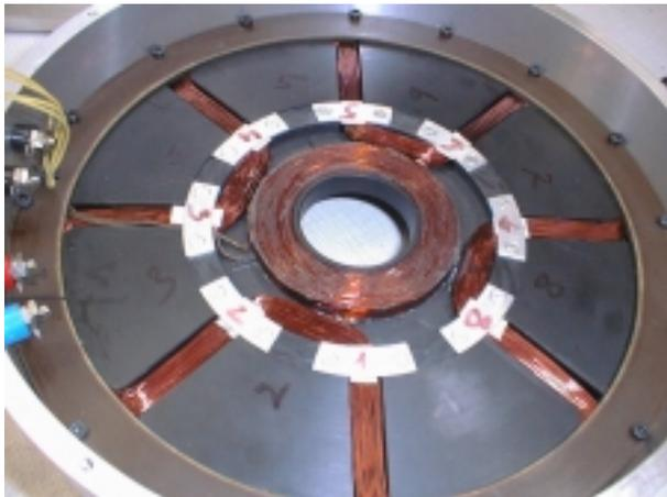
Fig. 2.1.1.a : Bobinage monophasé
