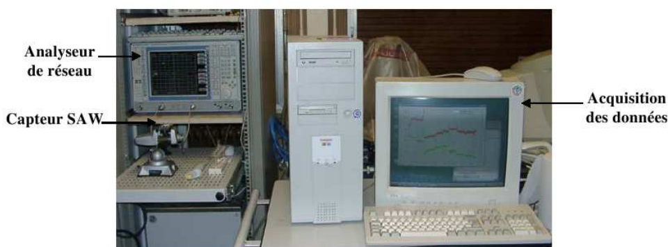
FIG. 5.4 – Acquisition des données de l'analyseur de réseau
