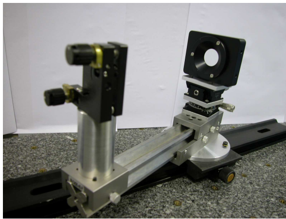
FIG. 8.14 – Le MD2 ou DM88 sur son rail de translation. Les câbles d’alimentation normalement à l’arrière du miroir ne sont pas présents. Le miroir au premier plan est un miroir de renvoi.
