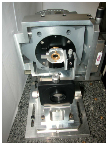
FIG. 8.17 – Photo de l'ASO grand champ d'HOMER : au fond on voit la caméra, devant, dans un support métallique, se trouvent les microlentilles. La lentille au premier plan permet d'avoir un faisceau collimaté sur les microlentilles.
