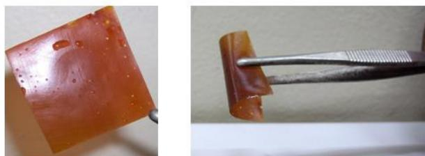
Figure 1 : Photographie d'une membrane flexible fluorophosphonée (M27)
