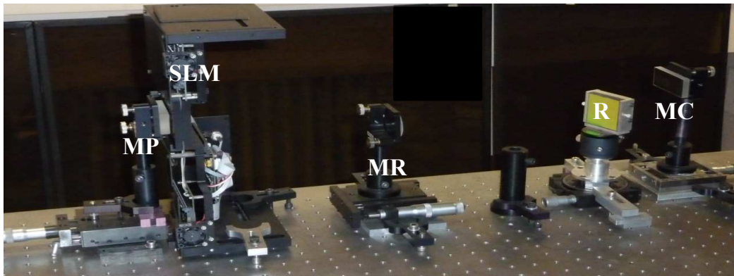
FIGURE III.5 – Photographie de la ligne à dispersion nulle repliée et du masque à cristaux liquides. R représente le réseau de diffraction, MC le miroir cylindrique, MR le miroir plan et MP le miroir permettant de replier la ligne.
