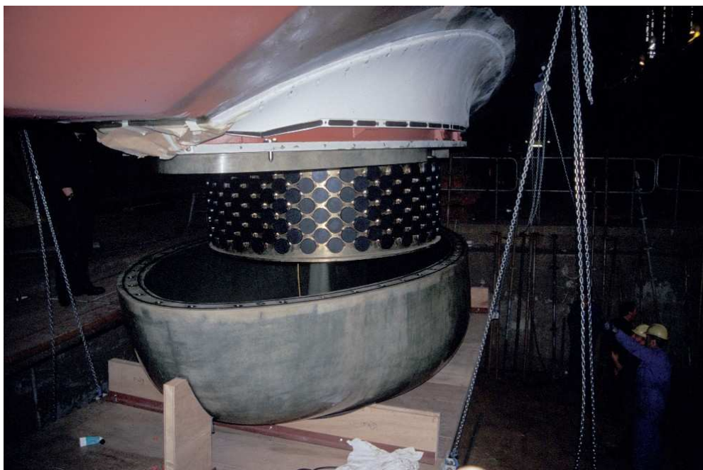
Figure 1 — Mise en place d'une antenne sonar et de son dôme sur un navire de surface
