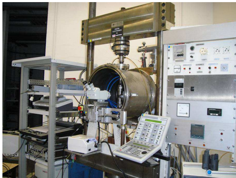
Figure 68: Machine d'essais de fissuration INSTRON avec enceinte d'environnement
