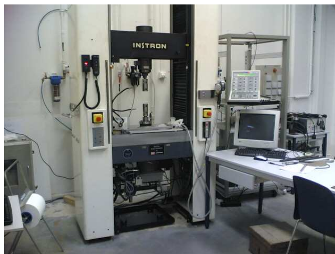
Figure 66: Machine d'essais de fissuration INSTRON 1251
