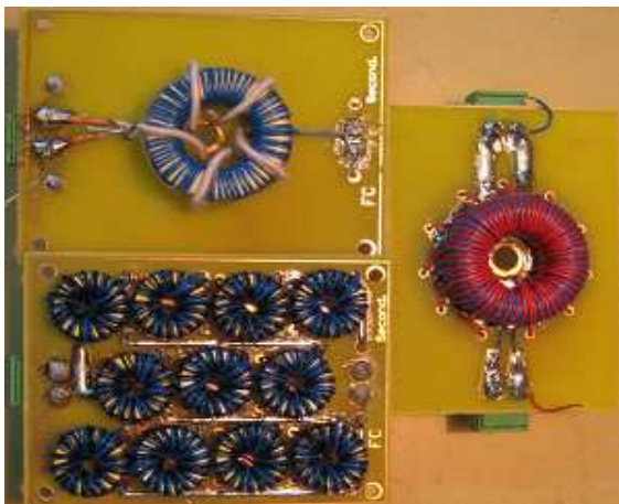
Figure I-14 : Image des trois transformateurs
