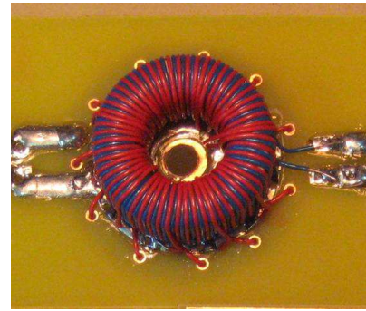
Figure I-12 : Image de la réalisation du transformateur SSWT
