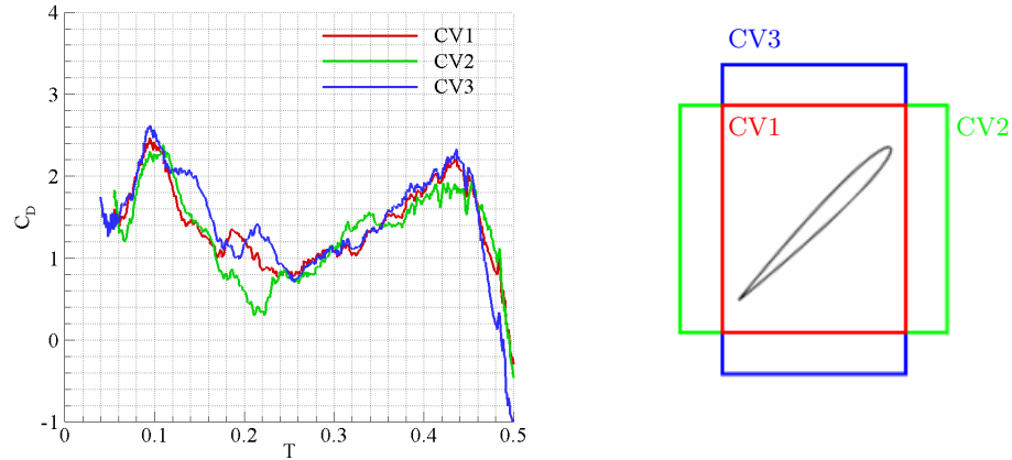
FIG. 3.33 – Influence du volume de contrôle sur la détermination expérimentale du coefficient de traînée généré lors de la phase d'upstroke d'un profil NACA0012 en vol battu symétrique.
