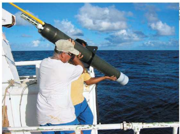
Figure 26: Déploiement d'un flotteur autonome de type Provor lors de la campagne océanographique Frontalis-3 en avril - mai 2005 dans le Pacifique tropical ouest. (Photo IRD: C. Maes)
