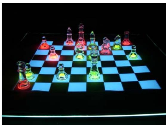
**Figure II-22** : Jeu d'échecs où 2 tailles de NCs de CdSe/CdS/ZnS ont été incorporées dans du PMMA puis déposées à l'intérieur de pièces d'échec en verre. La photo présente l'échiquier obtenu éclairé par une lampe UV ( $\lambda_{\text{ex}}=380$  nm).
