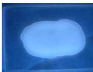
**Figure V-13 :** Mélange blanc incorporé dans du PMMA sous excitation UV ( $\lambda_{ex}=400$  nm).
