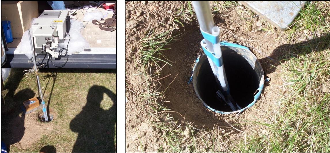
Figure 22 : Photos du capteur optique dans un puits pour une mesure de la concentration en CO<sub>2</sub>
