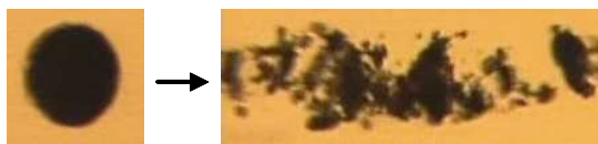
Figure 17 : Illustration du mécanisme de désintégration pour un agglomérat de silice Z1115MP dans du SBR. R_0=37 \mu\text{m} , \dot{\gamma}=56 \text{ s}^{-1} Photos extraites du travail de [Rou 08].
