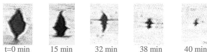
Figure 15 : Illustration du mécanisme d'érosion. Noir N234/SBR. R_0 = 22\mu\text{m} , \dot{\gamma} = 6\text{ s}^{-1} . Mécanisme observé dans le plan écoulement/vorticité. Figure extraite de [Col 04].
