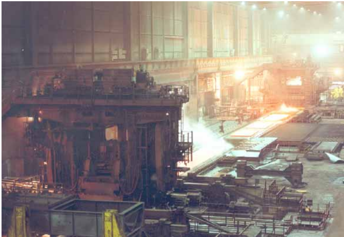
Fig. 2 Vue du laminoir de Dillingen. A l'avant-plan se trouve la cage finisseuse, à l'arrière plan le dégrossisseur et entre les deux la table d'attente
