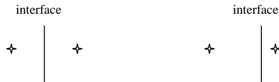
Fig. 17 Effet d'une norme euclidienne et non euclidienne sur la position d'une interface entre deux polyèdres de Voronoï
