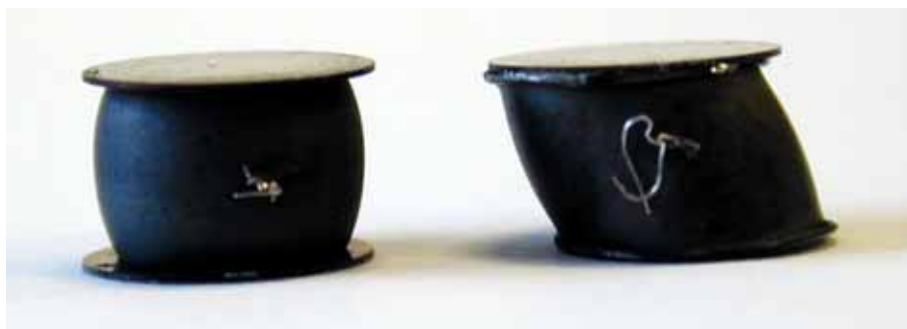
Fig. 1 Comparaison de deux éprouvettes de même géométrie, déformées dans les mêmes conditions (présence d'un cisaillement parasite) excepté le frottement, plus important pour l'échantillon à gauche que pour celui à droite.
