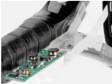
FIGURE 1.7 – Raquette HEAD intellifiber utilisant des fibres piézoélectriques contrôlées par un microprocesseur.
