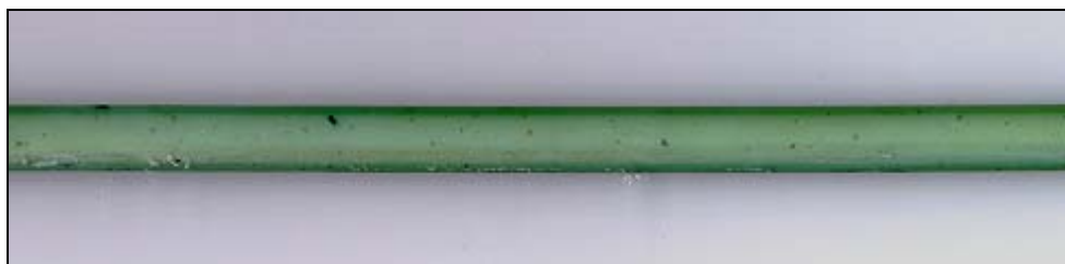
Figure 23 : Jonc de PET obtenu à vitesse de rotation optimisée : 68,8 tr/min
