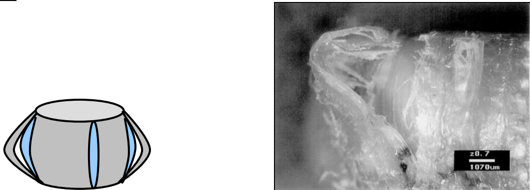
Figure 31 : Structure du type 3 . Schéma de l'échantillon après essai Photographie du plot. Décollement de la peau du plot dans le sens transversal Cœur du plot intact
