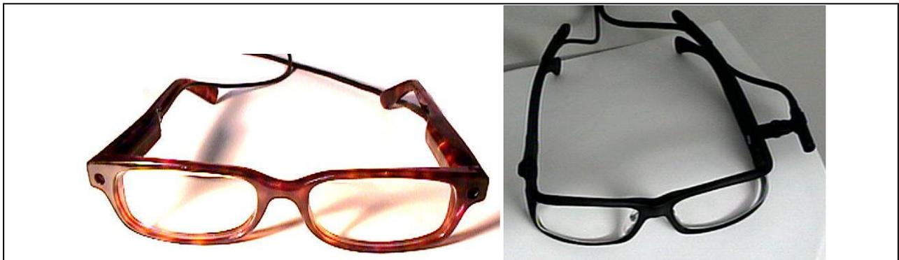
**Figure 11 : Les deux modèles de lunettes-caméra utilisés. A gauche, une caméra discrète et micro intégrés dans les branches, à droite une caméra et micro moins discrets montés sur rotule orientable**
