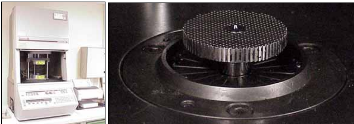
Figure I.44 : Viscosimètre Mooney MV 200E et son rotor strié
