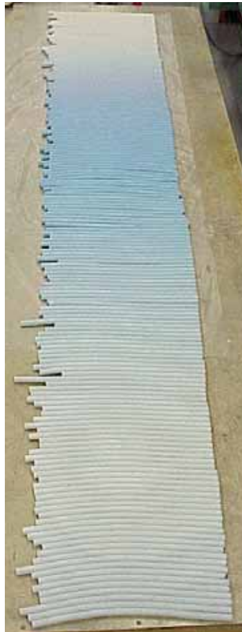
Figure II.78 : Evolution du jonc lors de la mesure du temps de séjour
