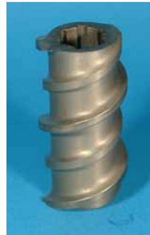
Figure II.60 : Elément D de convoyage 2D à filet tronqué, pas de 45 mm
