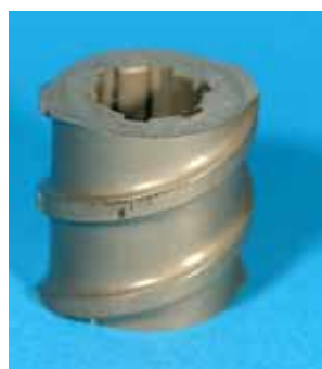
Figure II.62 : Elément A1 de convoyage 1D bi-filet, pas de 45 mm
