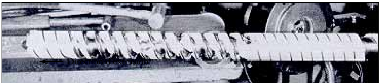
Figure II.17 : Evolution du remplissage de la vis [6]
