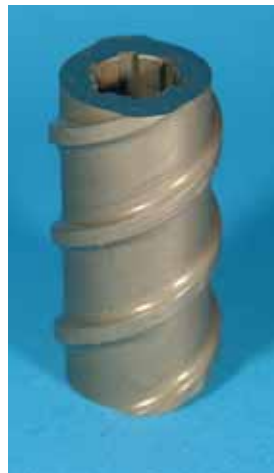
Figure II.59 : Elément H2 de convoyage 2D bi-filet, pas de 45 mm
