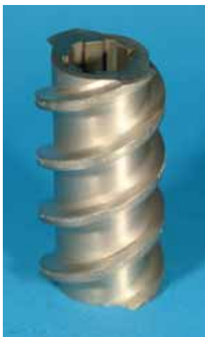
Figure II.58 : Elément E2 de convoyage 2D bi-filet, pas de 45 mm
