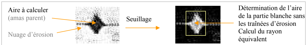
Figure 2-18 : Exemple d'image traitée pour l'érosion (a) avant seuillage (b) après seuillage
