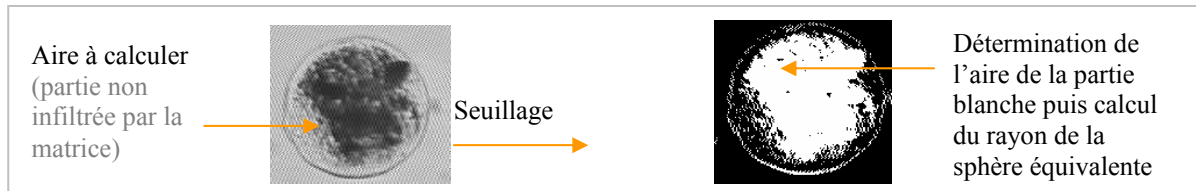
Figure 2-17 : Exemple d'image traitée pour l'infiltration (a) avant seuillage (b) après seuillage
