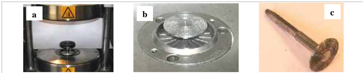
Figure 2-14 : Viscosimètre Mooney (a) Vue d'ensemble (b) Rotor en position de travail (c) Rotor
