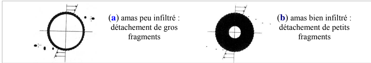
Figure 1-15 : Influence de l'infiltration de la matrice sur le mécanisme d'érosion, d'après [YAM 98b]
