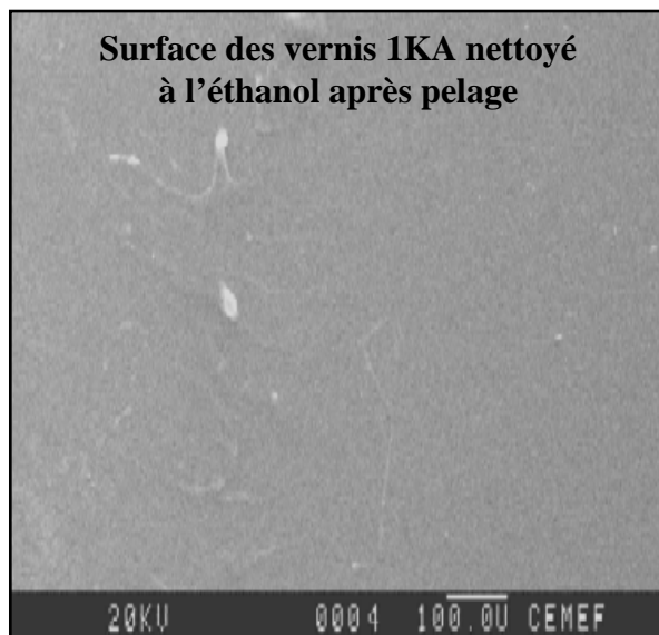
Fig. III.15 : Photographie au MEB des faciès de rupture côté vernis (nettoyé à l'éthanol avant collage) après pelage des HMPSA élastomères
