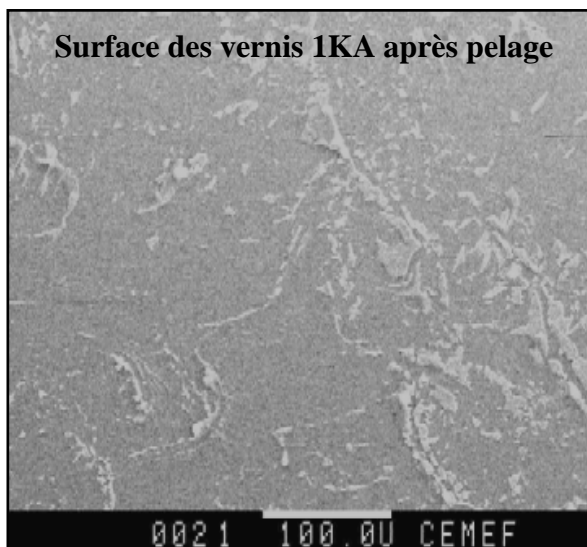
Fig. III.11 : Photographie au MEB des faciès de rupture côté vernis (non nettoyé avant collage) après pelage des HMPSA élastomères
