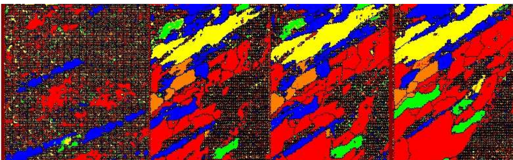
Planche 2: Analyse EBSD sur échantillon de compression 1 initial et suite à traitement thermique: orientation, analyse Kernel, facteur de Taylor
