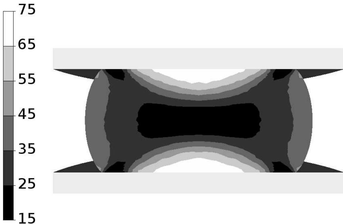
Figure 32: Taille des grains d'un pion de tantale issu de compression, Forge2005®
