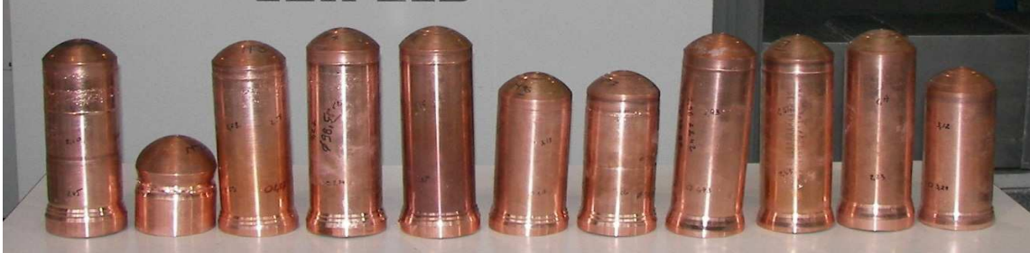
Figure 56: Pièces en cuivre fluotournées
