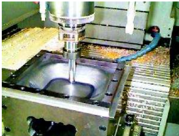
Figure 85: Procédé de formage incrémental [MCL02]
