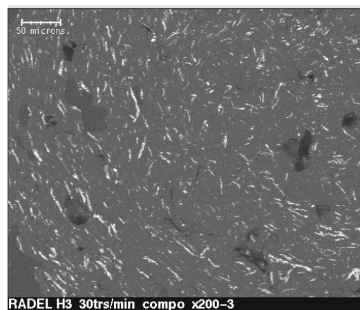
RADEL H3 30trs/min compo x200-3 Figure 140 Mélange de RADEL R5000 + 10% H3, réalisé à 360°C extrudé à 360°C, à 340 s -1 , vu au MEB x200
