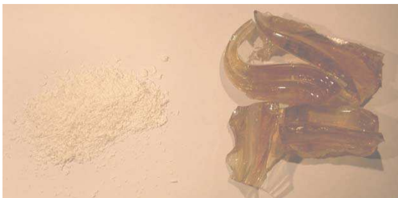
Figure 73 : Photographies du polysulfone sulfoné sodé (à gauche) et du polysulfone sulfoné sodé plastifié par 20% de polyéthylène glycol (à droite)
