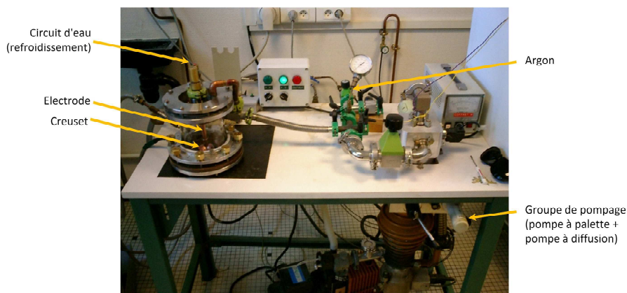
FIGURE 2.1 – Four à arc et ses principaux éléments
