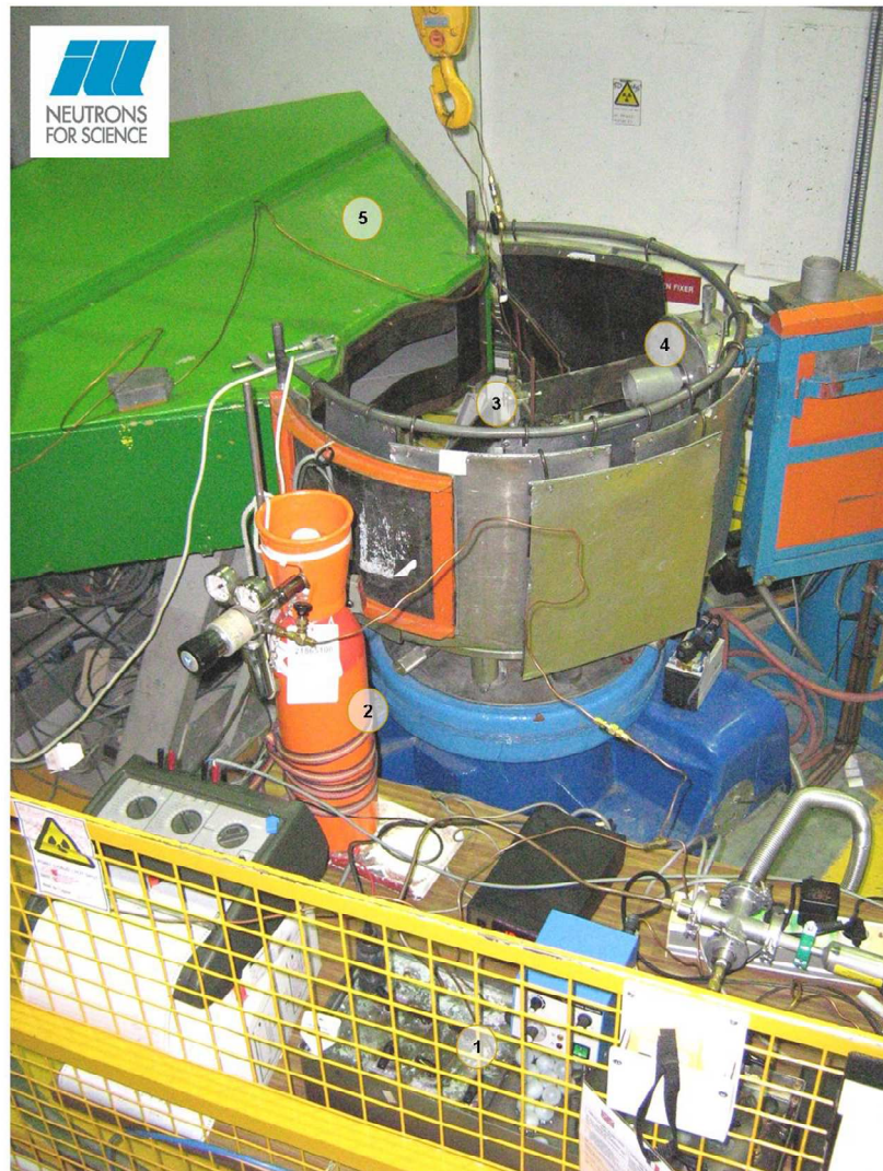
① : Banc volumétrique ; ② D_2 ; ③ Échantillon ④ faisceau incident ; ⑤ Détecteur
