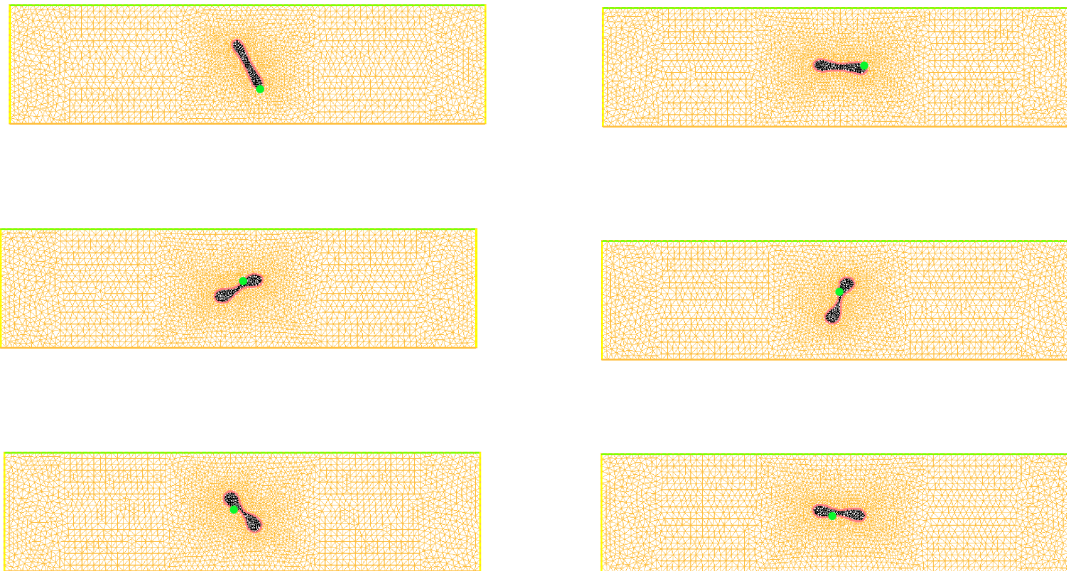
FIG. 1.8 – Mouvement de tumbling d'un globule sous cisaillement aux différents pas de temps suivants, de gauche à droite, de haut en bas : t = 0\text{s}, 2\text{s}, 4.5\text{s}, 5\text{s}, 5.3\text{s}, 5.7\text{s} .
