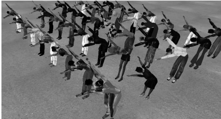
FIG. 3.15 – Plusieurs personnages de taille différente doivent résoudre les mêmes contraintes (deux aux poignets et deux aux pieds) en respectant l'équilibre (une contrainte supplémentaire sur le centre de masse) et en temps réel. Les deux personnages superposés devant montrent la différence de posture si l'équilibre n'est pas contrôlé.
