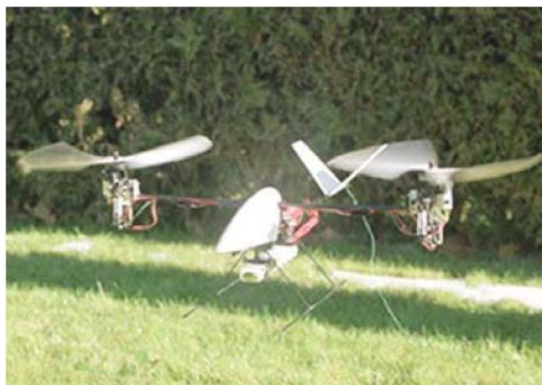
FIG. 2.9 – Prototype de birotors pivotants réalisé par Gary Gress en 2003
