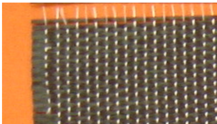
FIG. 3.13 – Nappes UD de carbone avec trames, (Hexcel G115 D1300)
