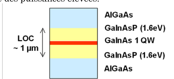
Figure III-1 : Structure verticale des diodes laser.
