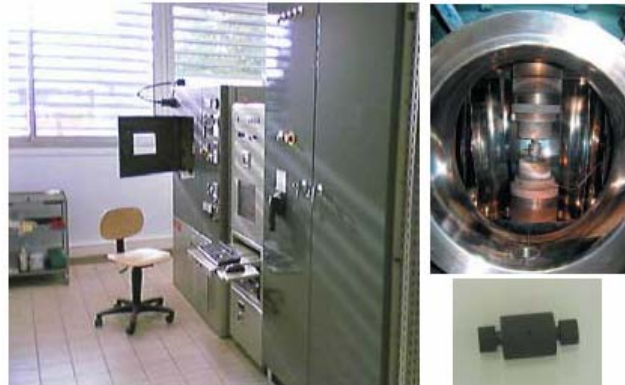
Figure III-5. Vue d'ensemble du dispositif SPS à la Plateforme Nationale de Frittage Flash (PNF2) au CIRIMAT-Toulouse (à gauche), chambre de traitement (à droite) et enceinte (en bas)
